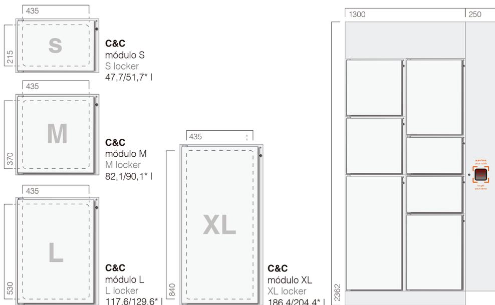
\*capacidade da versão pass-through pass-through model capacity
